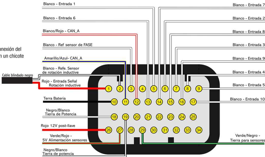
Diagrama para la conexión del conector da FT600 en un chicote FT500.
