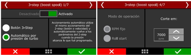
**RPM fijo:** define una rotación de corte para la carga de la turbina en una largada con el vehículo parado.
