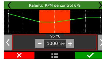
**RPM después del arranque (abertura automática)**
