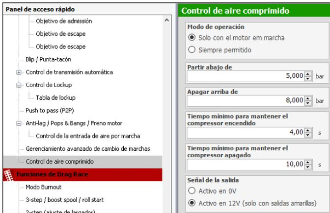
**Modo de funcionamiento:** seleccione si el compresor se pondrá en marcha siempre o solo con el motor en marcha.
