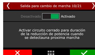
Seleccione a(s) salida(s) que se utilizará para accionar el solenoide de cambio de marchas, y también la señal de salida de un pulso (para cambio Air Shift), activado siempre (cambio Lenco) o una salida a la vez (cambio Liberty).
