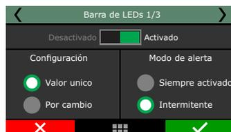
**Valor único:** seleccione el LED hacer editado, elija su color y el rango de RPM que debe ser activado. Este procedimiento debe realizarse para todos los LEDs, individualmente.
