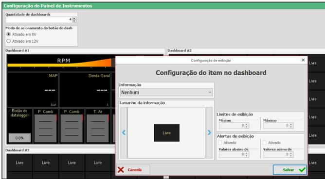
Para pasar de una pantalla en el módulo es necesario hacer clic en las esquinas superiores del módulo, como se muestra en la figura siguiente, o configurar una entrada en blanco para el intercambio de pantallas.
