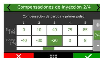
**Compensación de inyección rápida:** El siguiente ajuste se refiere a la inyección rápida. En general, los motores que se suministran con etanol necesitan más volumen de combustible en la inyección rápida que los motores abatidos con gasolina.
