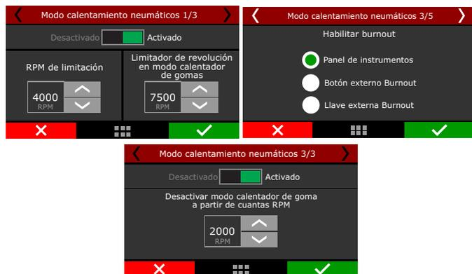
Se puede escoger si desea usar el “Mapa de ignición para corte de arrancada” o un valor de punto fijo durante el 2-step en el modo burnout. El “Enriquecimiento de combustible en el corte de arrancada” durante el modo burnout también es independiente y configurables.
