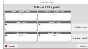
**Posiblemente desconectado:** Verifique la conexión del TPS según el capítulo 11 de este manual, si está correcta, el arnés eléctrico que va del TPS a la inyección está averiado. Revise con un multímetro si la tensión en el cable anaranjado varía según la posición del acelerador.
