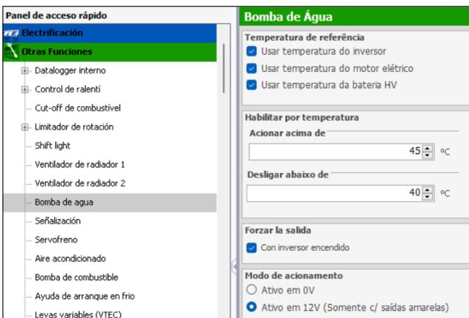
**Temperatura de referencia:** marca qué temperaturas se dispararán la bomba de agua, el inversor, el motor eléctrico o el paquete de baterías.
