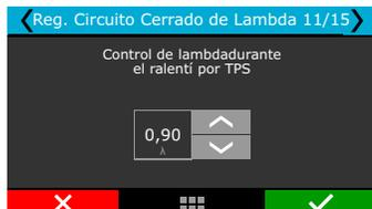
Límites de control, es una tabla en la cual posee, hasta 16 puntos siendo 8 columnas y 2 líneas, con valores totalmente configurables, siendo por posición del acelerador (TPS) o por presión absoluta del colector (MAP), que define los límites de actuación de control de circuito cerrado de lambda, permitiendo así evitar que el control remueva. Remueve o aumenta el exceso de combustible conforme con la configuración del usuario.
