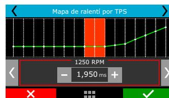
Este menú solamente estará disponible cuando la lenta esté configurada por "TPS". La configuración del tiempo de inyección para lenta es realizada conforme a la rotación del motor, haciendo posible un mejor ajuste de los motores que poseen vacío inestable en esta condición y necesitan ajuste preciso.
