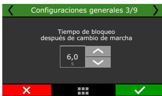
Configure el retraso y el porcentual de TPS o pedaleo el acelerado, esa configuración evita que el cambio troque varias marchas cuando el acelerador es pedaleado.
