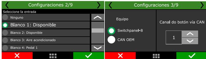
Al seleccionar las opciones del panel de instrumentos, la llave externa o botón externo se puede configurar si el control está activado o desactivado al conectar la ECU.
