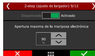
Para evitar que el piloto accidentalmente accione el 2-step luego de la largada, se puede configurar dos parámetros de seguridad: un bloqueo por tiempo y un bloqueo por RPM. De esta forma, mismo que el piloto accione nuevamente el botón del 2-step, el no será activado antes del fin del tiempo de bloqueo o si estuviera arriba de las RPM de seguridad.
