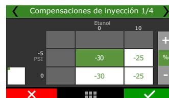
**Partida y primer pulso:** La siguiente tabla permite configurar los tiempos de inyección en la partida y la compensación después de la partida.
