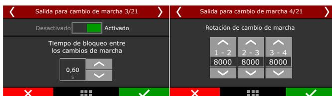
Esta reducción puede configurarse por tiempo (ms), retraso o corte de ignición.
