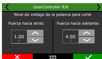
El nivel de tensión de corte se hace para desenganchan los engranajes, de modo que la fuerza de corte detrás de la tensión se refiere a la operación de corte para desenganchan los engranajes impares (primera, tercera, quinta). Desde que el fuerza de avance se refiere al corte enviado para desenganchan las marchas pares (2, 4).
