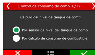
Cuando el vehículo está equipado con un flotador de combustible, es necesario definir una entrada para leerlo. También defina el tipo de sensor utilizado y si hay algún desfase de lectura, estos se pueden ajustar.
