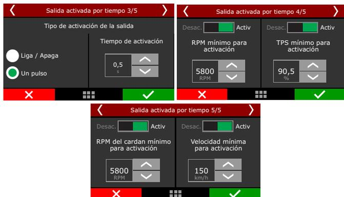
Esa salida puede trabajar de manera conecta/desconecta (siendo desconectada cuando una de las condiciones deja de ser válida) o como un pulso (para casos como el de accionar el paracaídas). Las condiciones que pueden ser configuradas son unas RPM mínimo para accionamiento, TPS mínimo para accionamiento, RPM mínimo del cardan, y velocidad mínima para accionamiento.
