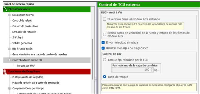
**El vehículo tiene instalado el módulo ABS:** esta opción permite obtener velocidad a través del sensor ABS.
