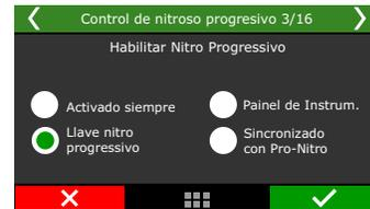
La opción "Salida progresiva" permite hacer con que los porcentuales de nitro configurados en la tabla sean alcanzados progresivamente, conforme a la abertura del TPS. Configure un valor de TPS para iniciar el control progresivo y otro para asumir 100% de que fue configurado en la tabla.
