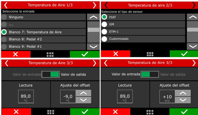
La FT tiene entradas totalmente programables, lo que permite que cualquier sensor análogo o digital sea utilizado para leer la temperatura, bastando que su escala de presión y tensión sea conocida. En este caso, seleccione la opción "Personalizado" y complete la tabla de lectura del sensor a través del software FTManager y cable USB.
