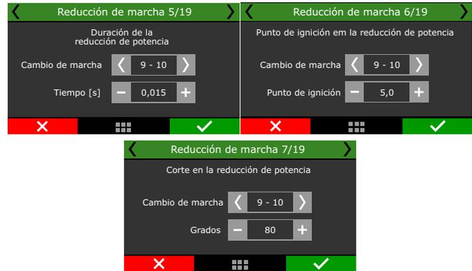
**Control de circuito cerrado:** cuando esta opción está activada, la función controlará el tiempo de corte, si la marcha se acopla antes de que finalice el tiempo de reducción de potencia configurado, esta opción anticipa el retorno de potencia del motor.
