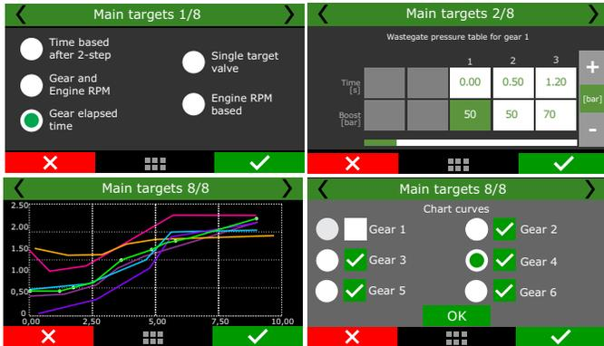
**Valor de objetivo único:** Define un valor fijo de presión para el BoostController. La válvula wastegate trabajará siempre en este valor. Esa configuración es recomendada para la utilización en testes de dinamómetro.
