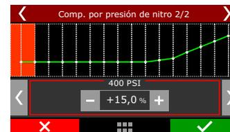
**Mapa de ignición Pro-Nitro:** Se puede configurar un atraso para el inicio de la compensación de la ignición, ese atraso debe ser configurado en base al tiempo que el nitro demora al llegar a la cámara de combustión. En el software FTManager es posible visualizar los valores del mapa final con esos valores calculados
