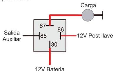
Las salidas auxiliares van a ser configuradas, conforme a la función deseada, en las salidas (cables de color azul, gris o amarilla) que no han sido utilizadas como salidas de inyectores o de ignición.
