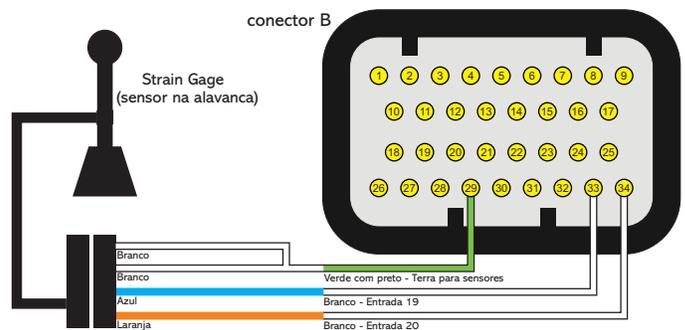
**Esquema de Conexión de la palanca del GearController para FT550 / LITE**
