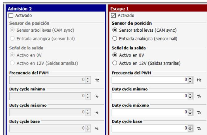
**Sensor de Posición:** Hay dos opciones para capturar la señal del mando. Por un sensor de fase o a través de un sensor Hall conectado en una entrada blanca.
