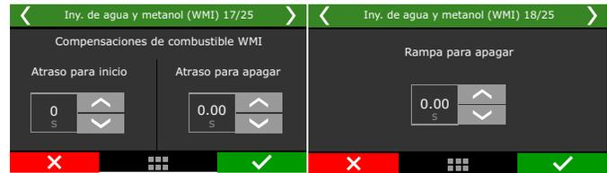
**Compensación de ignición:** Ajusta los retrasos para iniciar y detener la compensación, así como el tiempo de rampa para restablecer compensación.
