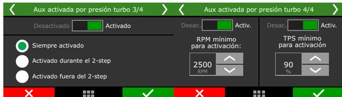
Existen 3 modos de activación: "Activar Siempre", "Activar durante el 2-step" o "Activar fuera del 2-Step". O sea, mismo que la salida este en la condiciones de vacío/presión para ser accionada, la condición de arriba debe ser respetada.
