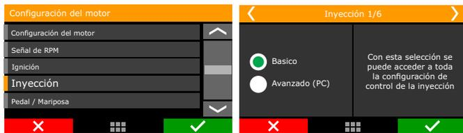
En este modo de configuración también es posible cambiar los intervalos de lectura de vacío y presión del motor, apertura de la mariposa (TPS) y rotación del motor, posibilitando personalizar la configuración según las exigencias del motor.
