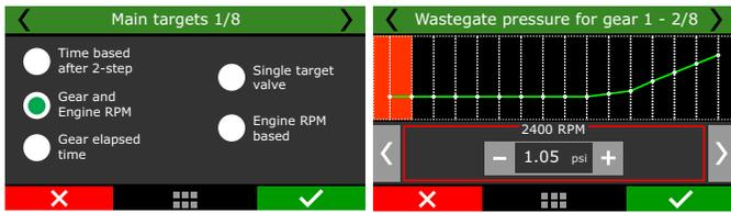
**Por marcha y tiempo pos cambio:** Configura un estágio para cada macha, con hasta 8 puntos por tiempo pos el cambio.
