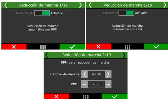
Si en la configuración se seleccionó la opción mediante TCU externo función de cambio automático, la función de cambio descendente se configurará desde la pantalla 3.
