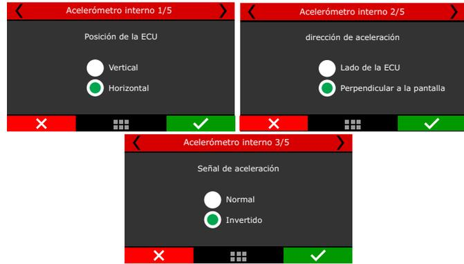
**Factor multiplicador del acelerómetro:** Calibración: el primer paso es calibrar el acelerómetro para compensar una instalación inclinada de la ECU, debe mostrar 0 G cuando el vehículo está parado y en nivel.
