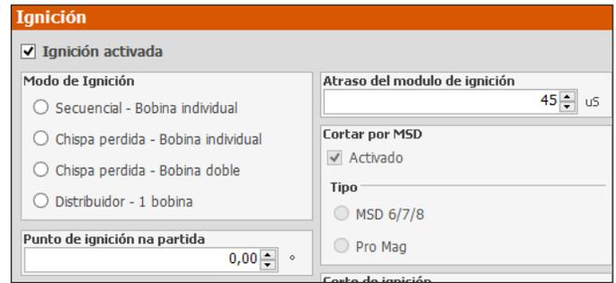
**Básico:** El modo "padrón" disponible en el menú de ignición comprende las configuraciones del modo de activación de ignición, como el modo de ignición, tipo de bobina y salida de ignición compatible.
