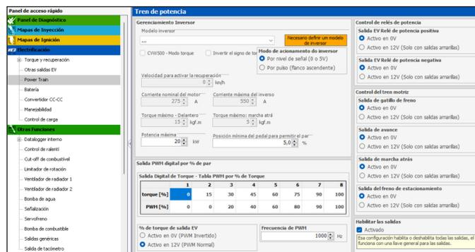
**Convertidor WEG CWV500:** Para este convertidor, es necesario definir el estrategia de reducción de potencia, la velocidad para activar el modo de regeneración, la posición mínima para el pedal, la corriente máxima y par nominal y en sentido horario y antihorario.
