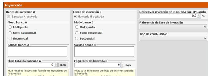
**Básico:** El modo "padrón" disponible en el menú de Inyección comprende las configuraciones del modo de activación de la inyección, de la configuración de los bancos de inyectores A y B y de la referencia de la fase de inyección.
