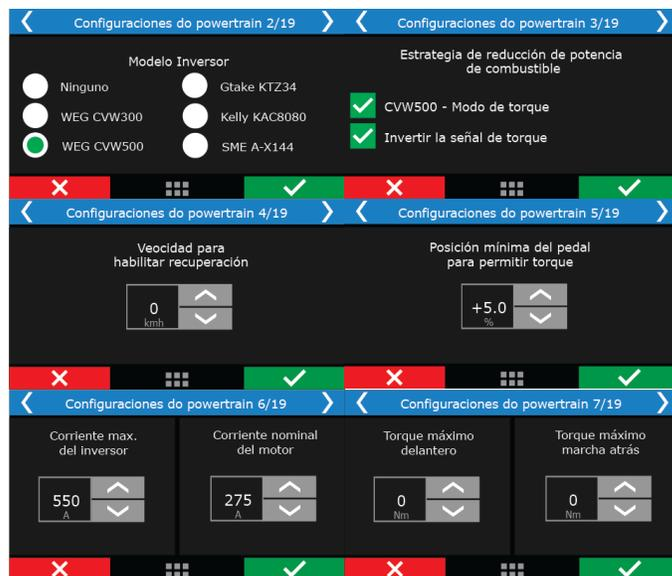
**Convertidor WEG CVW300:** Para este convertidor, configurar el porcentaje pedal mínimo para permitir par, corriente máxima y nominal del motor y también el par en sentido horario y antihorario.
