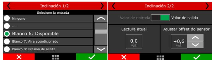
A través do Software FTManager os sensores de presión de nitró, posición de embrague, presión de embrague, sensor de altura e sensor de inclinación, poden ser configurados a través do menú "Sensores e Calibración" e entro "Entradas".
