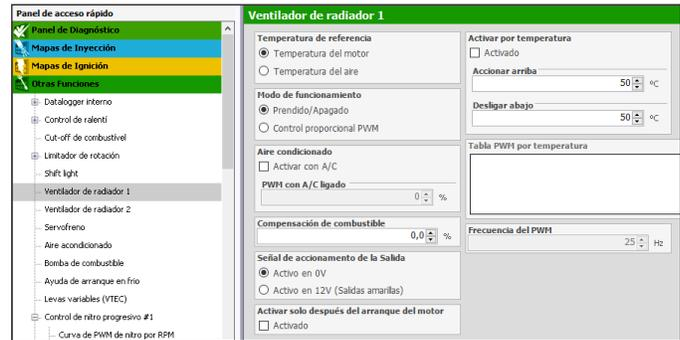
**Control Prendido/Apagado:** El accionamiento del ventilador se realizará según las temperaturas de Activación y desconexión configuradas. También hay la opción de accionar el ventilador al mismo tiempo que el aire acondicionado del vehículo está conectado. Para ello, seleccione la opción "Prender con aire acondicionado".
