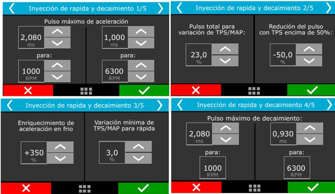
La inyección rápida es un aumento en la cantidad de combustible cuando se realiza una rápida variación del acelerador.
