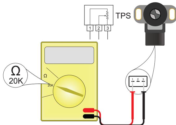
Con un multímetro en la escala de 20k Ohm, desenchufe el arnés de la inyección y deje la llave de ignición desconectada. Realice la medición entre los cables Verde/Rojo y Negro del conector de la FT. La resistencia no debe variar al acelerar. Si varía, invierta los cables de
