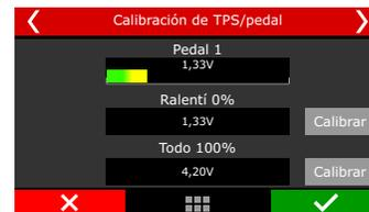
El TPS debe ser calibrado durante la primera vez que se opera a inyección, necesitando sólo hacerse un nuevo calibrado si éste llega a ser reemplazado, o tenga su curso desplazado. Este calibrado no se pierde cuando se desconecta la batería del vehículo o el módulo de inyección, además, el calibrado del TPS es guardado individualmente por ajuste.
