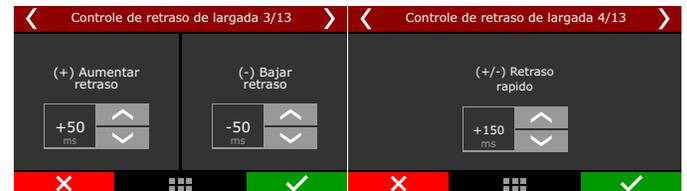
La siguiente configuración es el corte previo al arranque, donde es opcional, esta configuración le permite establecer un objetivo de RPM más bajo para "salvar" el motor. Cuando suelte el botón de 2-step, el motor se mantendrá en las RPM objetivo, el tiempo de los retrasos comenzará a contar y "X" (anticipación) milisegundos antes de que finalicen los tiempos, las RPM se elevarán al valor definido en la función de 2-step.
