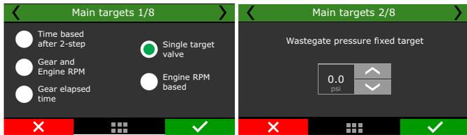
**Por RPM del motor:** Ajusta la presión de la válvula wastegate conforme a la rotación del motor.
