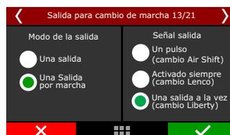
Seleccione la salida que hará el accionamiento del solenoide de cambio. Se enumerarán todas las salidas, menos las que están configuradas como salidas de inyección o ignición. Por el software FTManager, seleccione la salida a través del menú "Sensores y calibración" y luego "Salidas".
