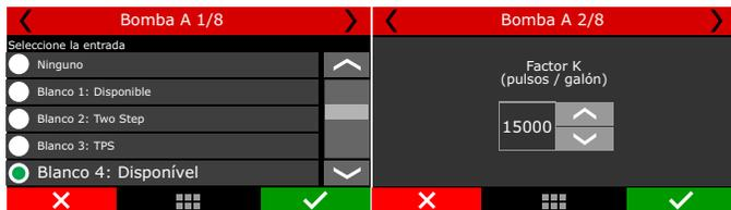
Después de la entrada configurada es necesario hacer el mismo procedimiento para la línea del retorno del combustible.
