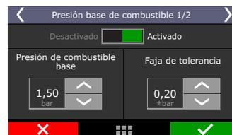
La presión diferencial es la presión de combustible con MAP =0, que, en la mayoría de los casos es de 3bar, con motor desconectado y bomba de combustible conectada. Cuando el motor entra en funcionamiento, en el régimen de lenta el vacío/presión hace que el regulador de presión de combustible cambie la presión de combustible en proporción de 1:1.
