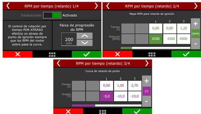
El primer parámetro solicitado es la faja de progresión de RPM, que es básicamente una faja de RPM en que los atrasos de punto configurados serán gradualmente aplicados.
