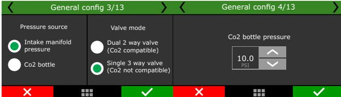
**Modelo de válvula:** Es posible escoger cual modelo de válvula será utilizado, inyector de alto o bajo flujo, bloc de 2 válvulas FT o válvula BoostController2. Es posible configurar un valor mínimo para activación del BoostController a través del TPS y MAP.
