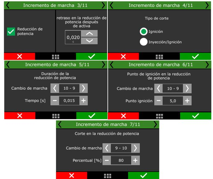
**Control de circuito cerrado:** cuando esta opción está activada, la función controlará el tiempo de corte, si la marcha se acopla antes de que finalice el tiempo de reducción de potencia configurado, esta opción anticipa el retorno de potencia del motor.
