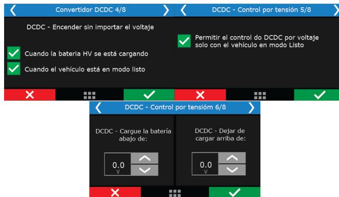
**Permitir DC/DC con SOC arriba:** En esta configuración le permite crear un límite de carga para que la batería pueda comience a cargar la batería de 12V del vehículo.
