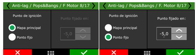
Ajuste el retardo de la activación, la duración máxima de actuación, las RPM mínimas, el TPS máximo y el enriquecimiento de combustible para que la función funcione correctamente.
