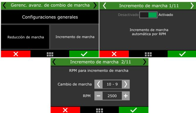
Si en la configuración la opción fue seleccionada por TCU externa o función de intercambio automático, la función de cambio ascendente se configurará desde la pantalla 3.
