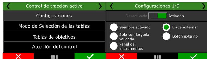
Si se seleccionan las opciones **Llave externa** o **Botón externo** es necesario configurar una entrada blanca o vía red CAN (SwitchPanel-8 o CAN OEM).
