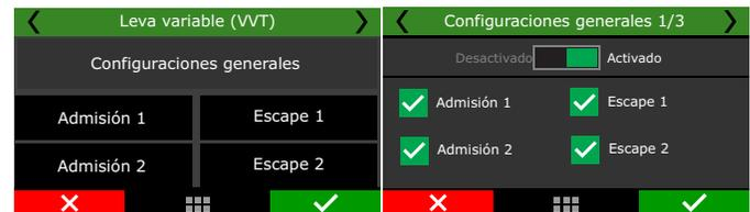
Tiempo de activación después de la partida: configura un tiempo de bloqueo para accionar el WT, este tiempo ayuda la partida do motor.
