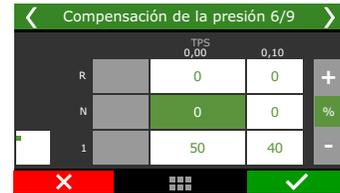
**Compensación de presión por temperatura:** esta tabla le permite establecer valores de compensación porcentual para la presión hidráulica con respecto a la temperatura, esto ayuda al transmisión a alcanzar la temperatura de trabajo más rápidamente
