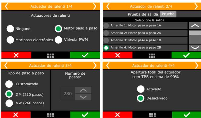
La opción "Abertura total del motor de paso con TPS superior a 90%" abre totalmente el motor de paso cuando el TPS está por encima de 90%, aumentando la cantidad de aire admitida.
