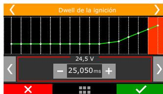
Variaciones de voltaje de la batería influyen el tiempo de carga de la bobina de ignición (Dwell) y en consecuencia, la calidad de la chispa, principalmente en motores que no utilizan alternador.
