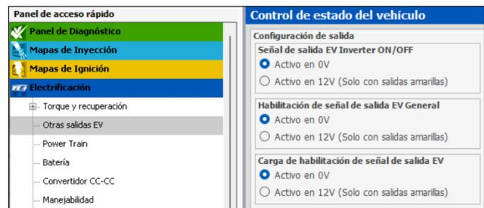
**Señal de salida EV inverter ON/OFF:** Salida responsable de puesta en marcha del inversor del vehículo.
