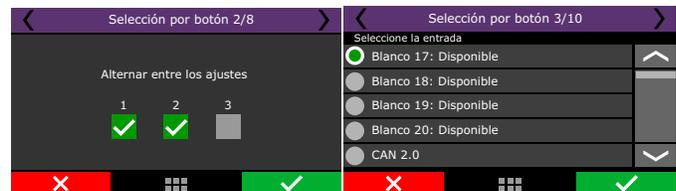
Si es a través de una entrada blanca, es necesario configurar qué tipo de activación es 0V o 12V. En el caso de elegir la red CAN, simplemente seleccione el botón o botones del panel que se asociarán en el software FTManager en el menú “Sensores y calibración / comunicación CAN - Panel de interruptores FT” o directamente en la ECU.
