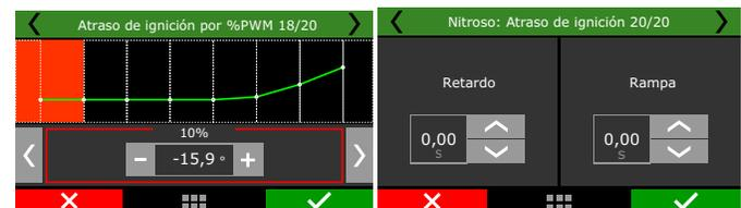
Por último están los tiempos para desactivar las compensaciones de ignición y son usados, pues mismo pos cesar la inyección de nitro, el múltiple de admisión del motor estará lleno con mezcla aire + nitro que será consumido por el motor en seguida. El tiempo de la rampa hace con que la compensación de ignición sea desactivada progresivamente.
