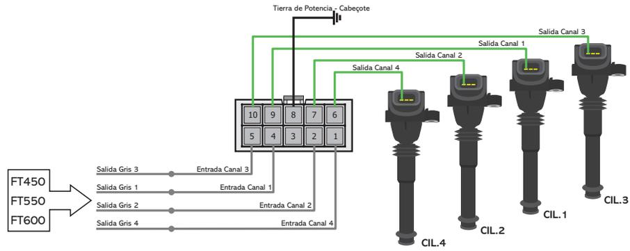
**Bobinas dobles – conexión eléctrica**
