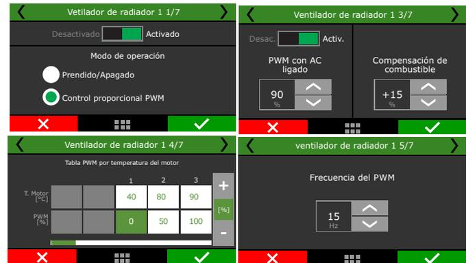
**Control proporcional PWM:** El ventilador, en lugar de un relé convencional, será accionado a través de un relé de estado sólido(lo que permite un control PWM), configure una tabla con la temperatura del motor y el % de PWM que accionará el ventilador, esto crea un control muy lineal de la temperatura del motor.
