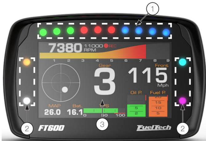
Para acceder a los menús, presione la pantalla dos veces, como si fuera un doble clic. Ello facilita la operación del módulo con el vehículo en movimiento y evita errores al navegar por las opciones.
