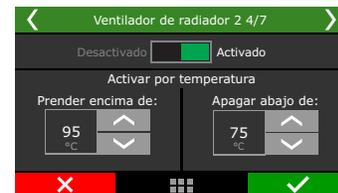
El ventilador de radiador se puede configurar con temperaturas de motor, aire, transmisión, inversor y incluso sigue la bomba de agua.
