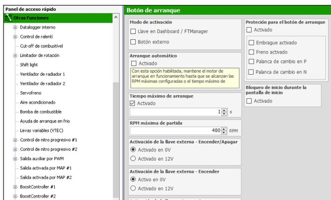
Seleccione si desea conducir a través de la pantalla del panel de instrumentos FT (para configurar la opción "Botón de partida" en el panel de instrumentos) o por medio de un interruptor externo.
