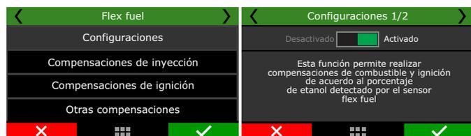
Si el sensor se desconecta o presenta un error de funcionamiento, la ECU utilizará las compensaciones configuradas en las tablas con el valor del porcentaje configurado en ese menú.
