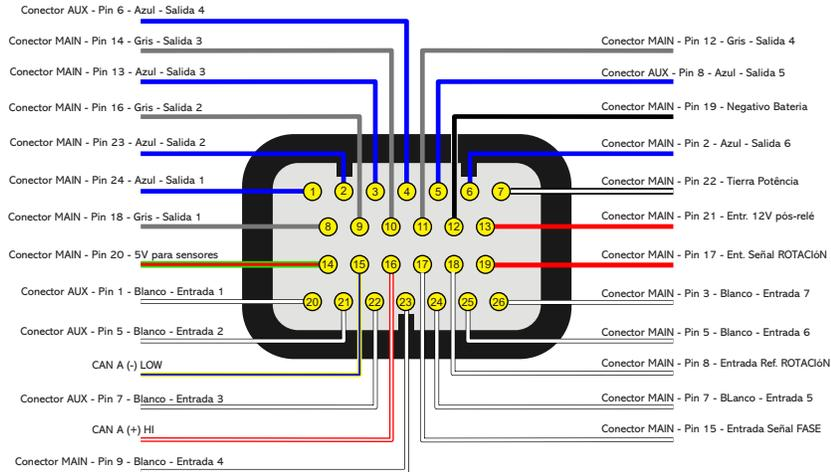
Diagrama para la conexión del conector da FT600 en un chicote FT500.
