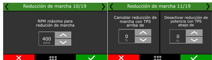
**Reducción de potencia adicional para después de la marcha engranada:** estos ajustes son necesarios porque antes de la reducción de marcha se activa el blip elevando las RPM del motor, con lo que el coche tiende a "empujar" indebidamente dificultando el control.
