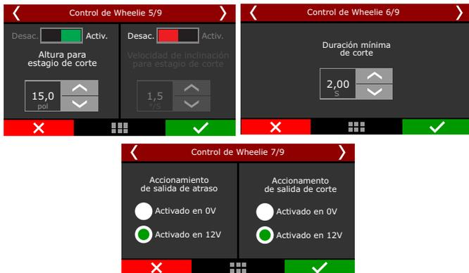
Así como el estagio de atraso, hay configuraciones de altura y tasa de inclinación para el estagio de corte. El corte aplicado es del 90% y se puede configurar el tiempo de duración de este corte.
