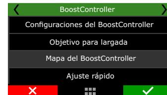
**Por tiempo pos 2-step:** Permite una rampa detallada con hasta 32 puntos de tiempo. Los valores intermedios son interpolados.
