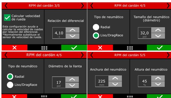
Para eso, coloque la relación del diferencial utilizado y en seguida las informaciones referentes a las dimensiones de las ruedas/neumáticos.
