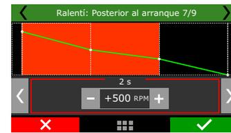
**Compensaciones por carga:** utilizadas para compensar cargas que son adicionadas de forma repentina en el motor y pueden causar variaciones de marcha lenta. Se puede configurar cuantas RPM se desea subir la marcha lenta cuando el aire acondicionado estuviera ligado, además de correcciones en porcentual en la abertura del actuador para los electro ventiladores
