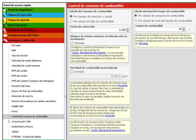
El primer paso es configurar el volumen del tanque de combustible del vehículo
