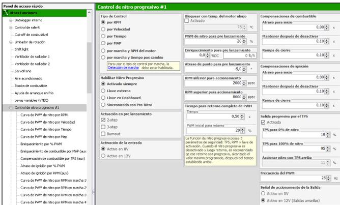
Configure una salida auxiliar como "Salida de Nitro". En seguida, seleccione como hará ese control: por tiempo (iniciado pos la liberación del 2-step) por rotación o por velocidad.
