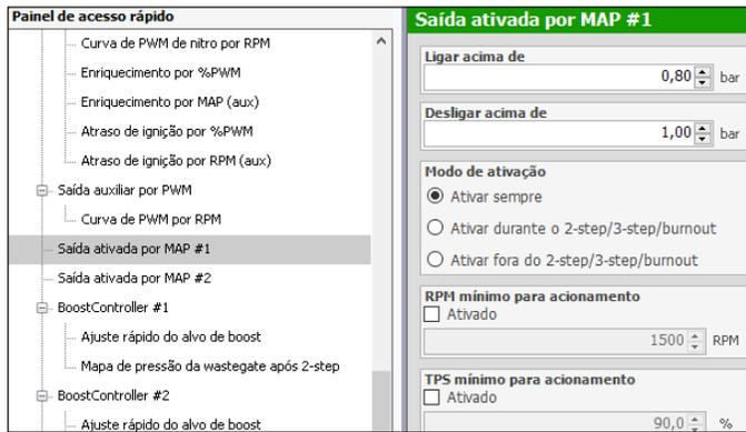
El sensor MAP necesita estar configurado en una de las entradas para efectuar el control de la salida.
