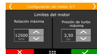
**Rotaci3n m3xima:** Se debe insertar la rotaci3n m3xima de trabajo del motor, el mapa de inyecci3n por rotaci3n y el punto de ignici3n van a ser creados hasta el l3mite configurado en este men3.
