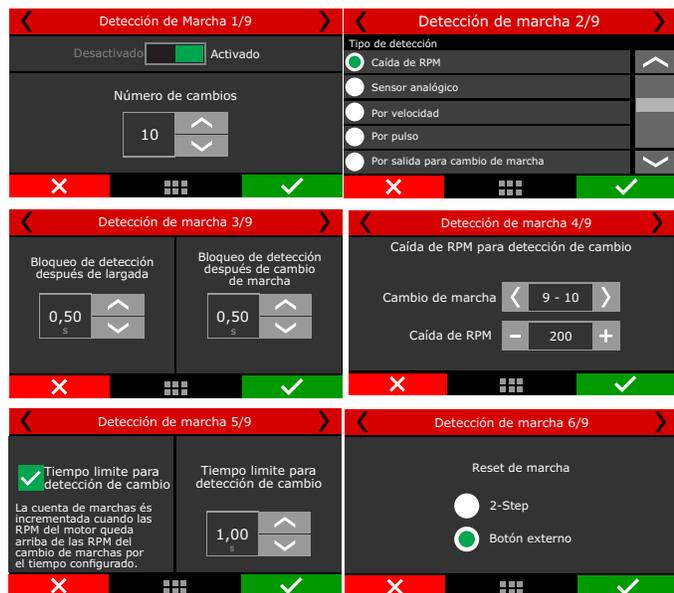
**Sensor analógico de cambio:** En este caso es necesario apenas indicar el número de marchas, el cable que hará la lectura del sensor de tensión que este envía de acuerdo con la marcha engranada. Para obtener los valores de tensión, engrane marcha por marcha y haga las mediciones con un multímetro en la escala de 20 Volts.
