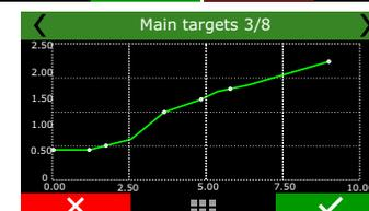
**Por marcha y RPM del motor:** configura un estágio para cada marcha, con hasta 8 puntos de RPM por marcha. Es necesario que la función de detección de marcha este ya activada. No depende del 2-step.
