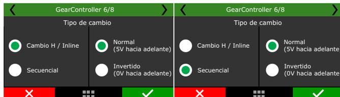
Con el vehículo parado, force la palanca hacia delante y comprobé la tensión se muestra en pantalla del diagnóstico FT. El recomendado es que la tensión desteja entre 4 y 4,5V (o entre 0,5 y 1V - para palanca con señal invertido).
