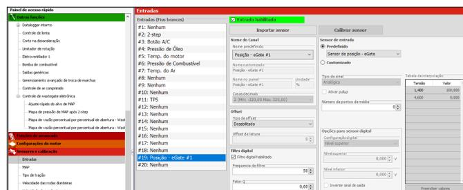
Después de configurar la entrada, es necesario calibrar la posición del eGate. Haga clic en el botón "Calibrar sensor", se abrirá una pantalla de calibración.
