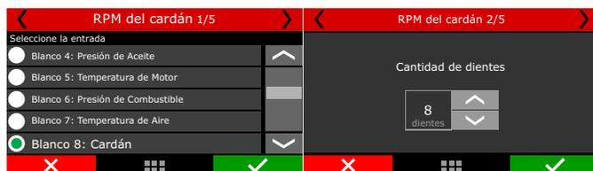
Con la velocidad del cardan y las informaciones de las dimensiones del conjunto rueda/neumático es posible calcular la velocidad de las ruedas de tracción. En caso que desee utilizar la velocidad del cardan en substitución a un sensor de velocidad de rueda, seleccione en la siguiente pantalla "Calcular velocidad de rueda".
