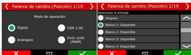
**Posiciones de palanca de cambio:** seleccione todas las posiciones que están disponibles en la palanca, generalmente se encuentran junto a la palanca o en el panel de instrumentos.
