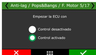
**Activación con freno:** configure si la función se activará cuando se pise o suelte el pedal del freno. Para esta configuración es necesario tener una llave instalada en el pedal del freno.
