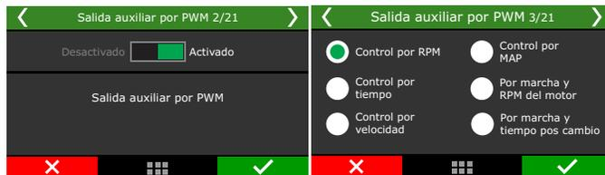
Al seleccionar la opción "Por marcha y tiempo después del cambio", es necesario definir si la función se activará siempre o solo después de un inicio válido (después de la validación de 2-step).
