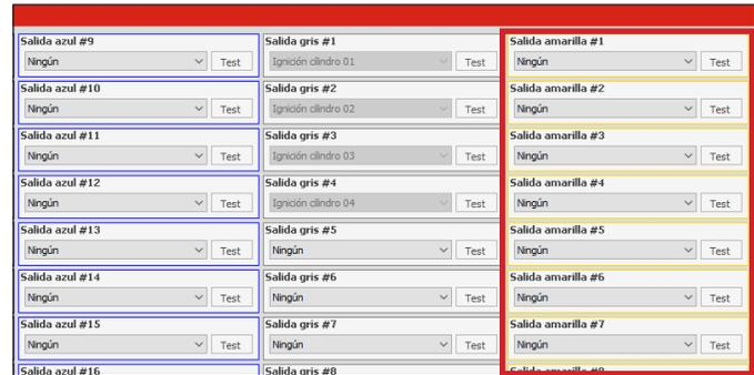
Seleccione las salidas para control de los cables motor 1 y motor 2 de la mariposa, por estándar son: amarillo nº3 (cable motor 1A) y amarillo nº4 (cable motor 1B). Si las entradas estándar ya están ocupadas por otro tipo de control, utilice la salida amarilla nº1 (cable motor 1A) y amarillo nº2 (cable motor 1B).
