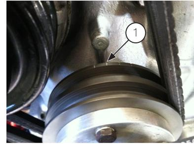
2. Alinear el "crank angle sensor" utilizando las marcas según mostrado en la siguiente foto.
