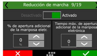
**Protección para reducción de marcha:** ajuste el valor de reducción de RPM para cada cambio de marcha, establezca el rango de bloqueo para la reducción de marcha con el porcentaje de TPS por encima y por debajo de "X"%.
