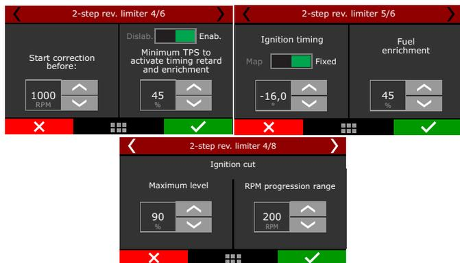
Es posible configurar el porcentual de pulsos de ignición que serán cortados para asegurar las RPM del motor durante el 2-step, además de una faja de progresión para aumentar gradualmente estos cortes. Ejemplo: en 2-step configurado para 8.000RPM: cuando el motor alcance estas RPM, el nivel de corte va aumentando progresivamente hasta llegar al nivel máximo de 90% en 8200 RPM (8000 + 200RPM de la faja de progresión).
