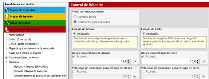
El estagio de atraso, atrasa el punto siempre que el frente del vehículo levante arriba del límite configurado, ya el estagio de corte, envía cortes de ignición para controlar la altura del frente del vehículo.
