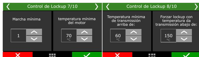
La última configuración es para deshabilitar el lockup en condiciones como el cambio de marchas o cuando el freno se aplica por debajo de ciertas RPM.
