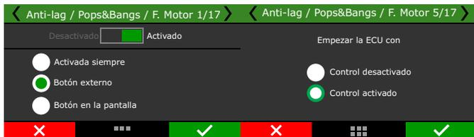
Si se configura un botón externo, es necesario definir cómo se operará el convertidor a través de una entrada blanca o mediante la red CAN a través de un Switch Panel.
