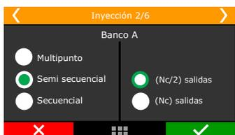
**Secuencial:** En el modo de inyección secuencial cada inyector es activado solamente una vez por ciclo del motor (720°). En este modo de inyección es imprescindible el uso del sensor de fase y una salida de inyección para cada inyector.
