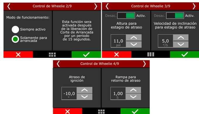
Se puede configurar la función para monitoria la altura del vehículo a todo momento, o, apenas luego de la arrancada. En este caso la altura solo será monitoreada hasta por 15s después a la desactivación del 2-step.
