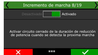
**Salida de incremento de marcha:** configure el solenoide que activará la palanca de cambios, y también la duración de la activación
