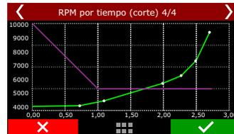
Al final de la configuración es exhibido un gráfico de compensación de punto en función del tiempo después de la largada.
