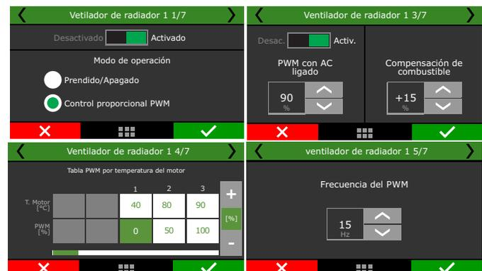
Ambos modos de funcionamiento se pueden configurar con temperaturas de referencia del motor o del aire.
