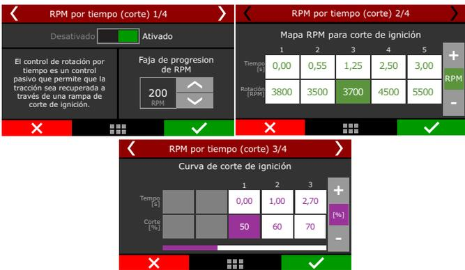
El parámetro inicial a ser configurado es la faja de progresión de las RPM, que sirve básicamente para suavizar el corte aplicado del motor. Usar una faja de progresión de 200RPM significa que, para aplicar un corte a los 8.000RPM, la ECU iniciará con nivel de corte bajo, y el aumentara progresivamente hasta alcanzar el valor configurado en la "Curva de corte de ignición".
