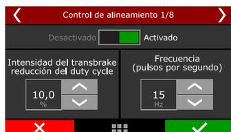
**Tiempo máximo de actuación de la salida (Protección de lo solenoide):** este tiempo máximo es proteger el sistema contra un tiempo excesivo de accionamiento que puede ocasionar sobrecalentamiento o daños al solenoide/cambio.
