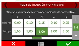
Es posible configurar un atraso para el inicio de la compensación de la inyección, ese atraso debe ser configurado con base al tiempo que el nitro demora en llegar a la cámara de combustión.
