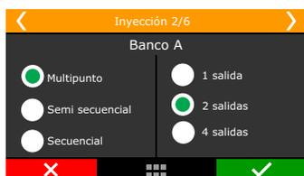
**Semis secuencial:** En el modo semis secuencial los inyectores van a ser activados en atención a los cilindros pares, o sea, en un motor 4 cilindros los inyectores del cilindro 1-4 serán activados al mismo tiempo, así como los inyectores 2-3 una vez por cada giro del cigüeñal. En este tipo de activación los inyectores pueden estar conectados a los pares o de forma individual, pues la configuración en el módulo es lo que va a determinar el modo de activación.
