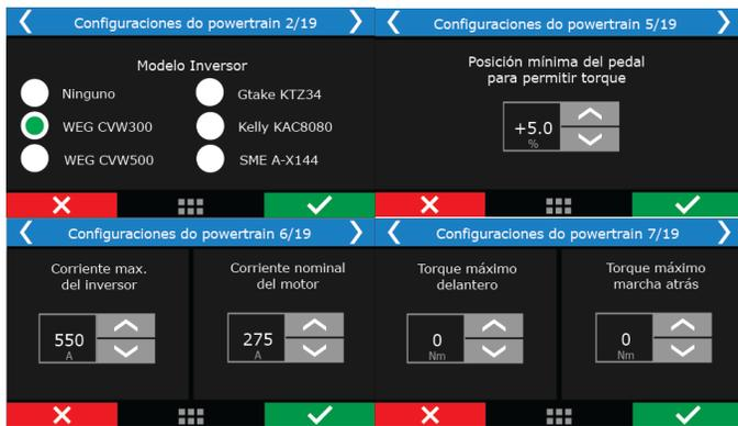
**Inversor Gtake KTZ34 / Kelly KAC8080 / SME A-X144:** configurar el porcentaje mínimo del pedal para tener torque, configurar el par en sentido horario y antihorario y ajustar la corriente nominal y máxima para el inversor.
