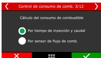
**Densidad del combustible:** La densidad varía según el tipo de combustible en el tanque. Este valor se completa automáticamente cuando se genera el mapa predeterminado cuando se elige el tipo de combustible del mapa.
