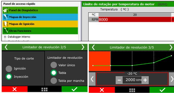
**Señal de RPM para limitador:** Hay tres modos de selección. RPM automático, convencional o RPM de alta resolución.
