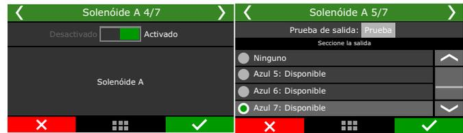
En el siguiente paso, es necesario definir la frecuencia y el tipo de activación por 0V (salidas azules o grises) o 12V (salidas amarillas).
