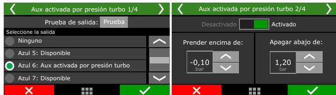
También puede configurar cuando la salida será activada. Las únicas salidas capaces de accionar un relé o carga por 12v son las amarillas. Defina la faja de vacío/presión en que esa salida será activada y desactivada.
