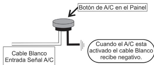
El aire acondicionado se mantendrá accionado mientras la "Entrada Señal A/C" reciba la transmisión del botón. La polaridad de la señal puede ser seleccionada y varía de acuerdo con la instalación original del vehículo o con la realizada en el amés.
