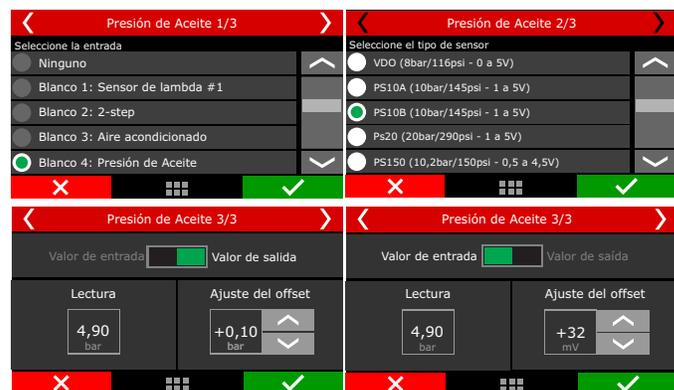
La FT tiene entradas totalmente configurables, lo que permite que cualquier sensor análogo o digital sea utilizado para leer la presión, bastando que su escala de presión y tensión sea conocida. En este caso, seleccione la opción "Personalizado" y complete la tabla de lectura del sensor a través del software FTManager y cable USB.
