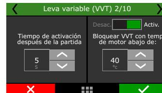
Rellene las tablas de objetivos de admisión y escape. Los valores que se deben colocar en las tablas son en grados, en relación con la posición física del sensor instalado.
