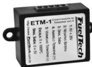
ETM-1 – Acondicionador de Termopar Tipo K
